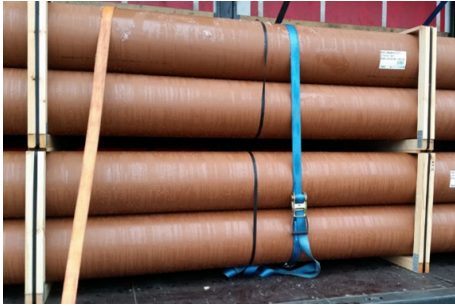
Varmista, että puuraamit ovat linjassa. Käytä välisidontaa aina kun mahdollista.
