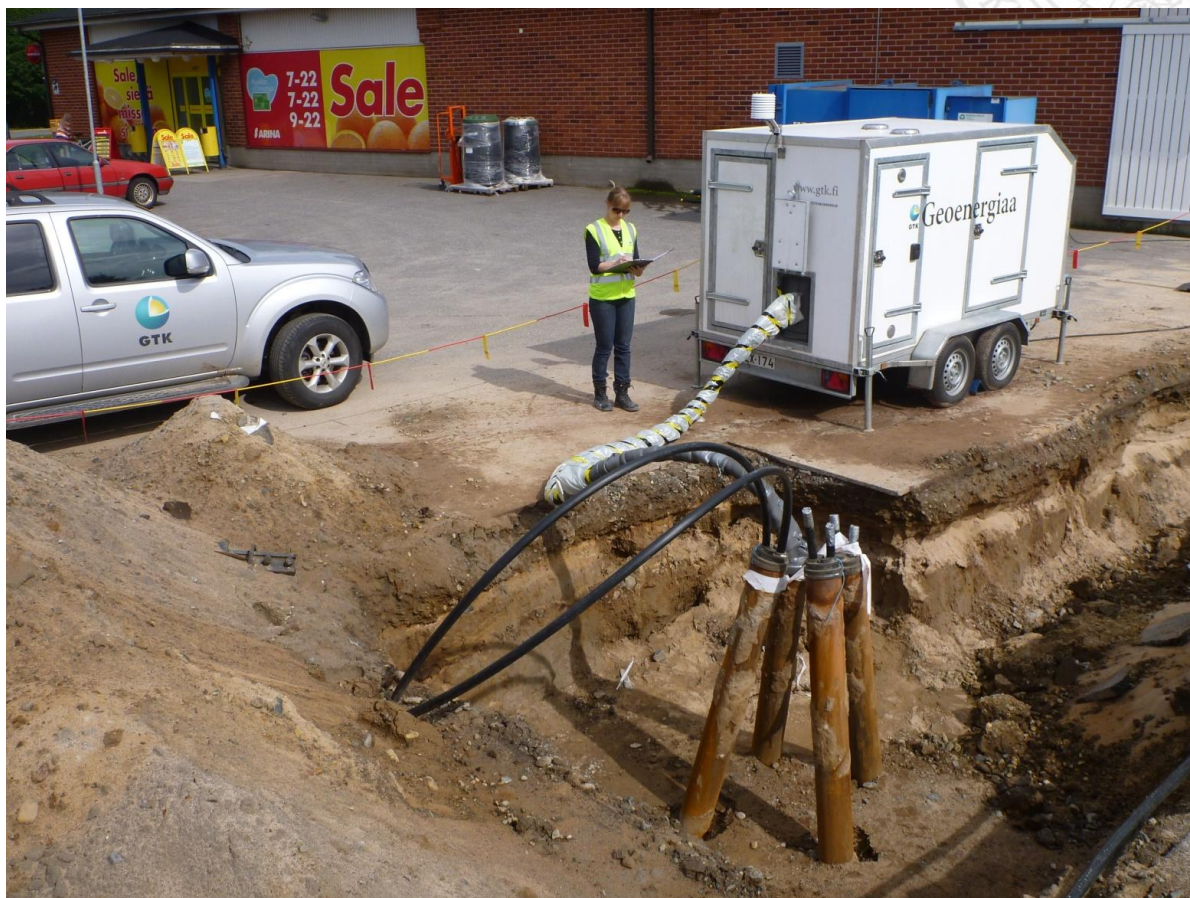
Kuva 4. TRT-mittaus käynnissä Dueta TM -putkessa.
